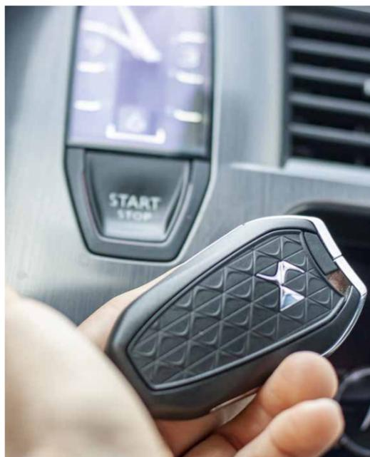
Viele Autos verfügen heutzutage über das Keyless-Go-System. Mit diesem ist es nicht mehr nötig, den Schlüssel aktiv zu bedienen, um das Fahrzeug zu öffnen bzw. zu starten, es reicht, den Schlüssel in der Tasche mit sich zu führen. Es handelt sich um Funkschlüssel, die mit der Elektronik des Fahrzeuges kommunizieren. Auch wenn sie bequem sind – diese Systeme haben ihre Schwachstellen, die Kriminelle ganz gezielt für Diebstähle ausnutzen.
